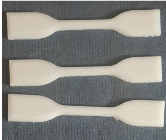
Gambar 7. Perendaman spesimen dengan waktu 2 jam
