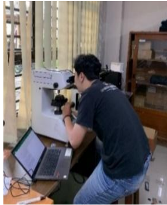
Gambar 8. Proses pengujian kekerasan vickers
