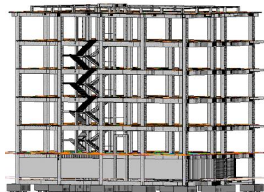
Gambar 2. Tampilan 3D View Komponen Struktural Pembetonan
