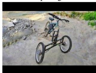
Gambar 2 Desain 2 *twinshock* sepeda listrik roda tiga
