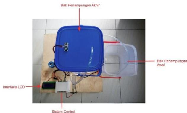
Gambar 11. Parent Node Sistem Akuisisi data
