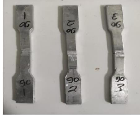
Gambar 6. Spesimen Arus 90 A Setelah Uji Tarik
