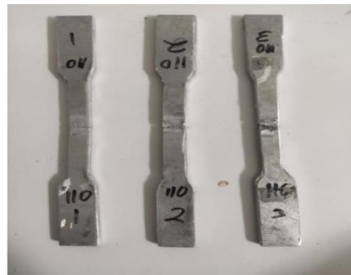
Gambar 8. Spesimen Arus 110 A Setelah Uji Tarik
