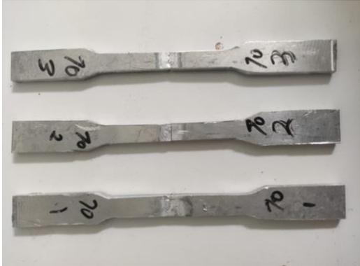
Gambar 4. Spesimen Arus 70 A Setelah Uji Tarik
