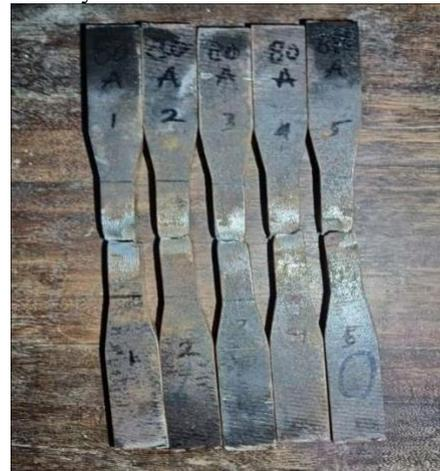
Gambar 3. Struktur Makro Pengelasan ST 37 dengan Arus 80 A
