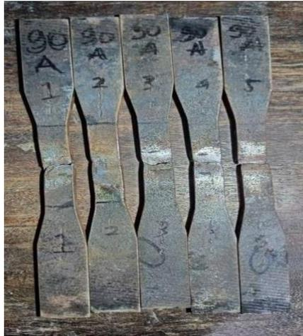
Gambar 5. Struktur Makro Pengelasan ST 37 dengan Arus 90 A
