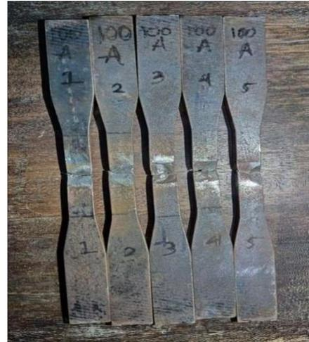
Gambar 7. Struktur Makro Pengelasan ST 37 dengan Arus 100 A
