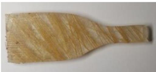
Gambar 6. Penampang patah komposit orientasi sudut serat 135°
