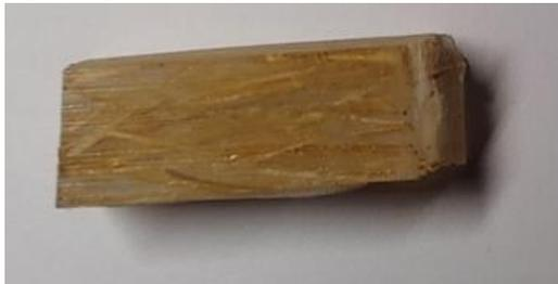
Gambar 7. Penampang patah komposit orientasi sudut serat  $0^\circ$
