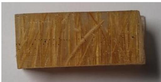
Gambar 9. Penampang patah komposit orientasi sudut serat  $90^\circ$
