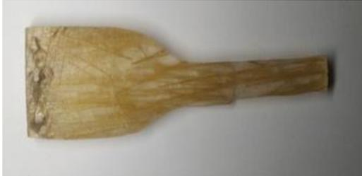
Gambar 3. Penampang patah komposit orientasi sudut serat 0°
