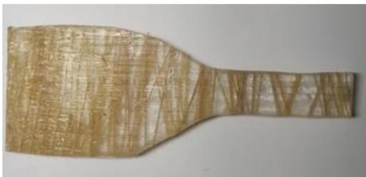
Gambar 5. Penampang patah komposit orientasi sudut serat 90°
