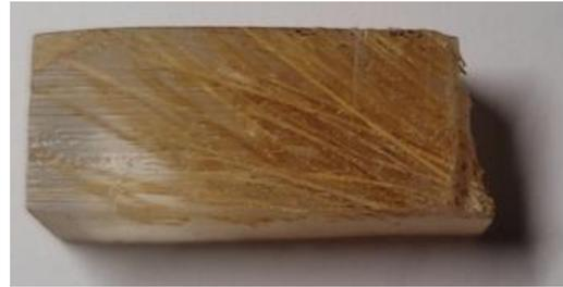
Gambar 10. Patahan patah komposit orientasi sudut serat  $135^\circ$
