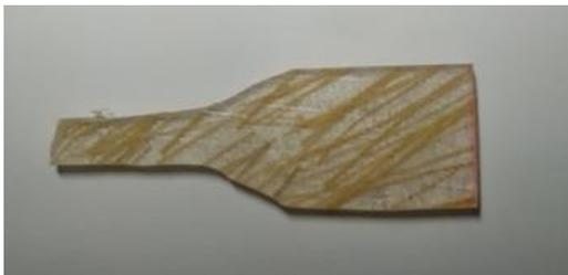
Gambar 4. Penampang patah komposit orientasi sudut serat 45°
