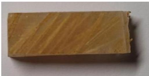
Gambar 8. Penampang patah komposit orientasi sudut serat  $45^\circ$
