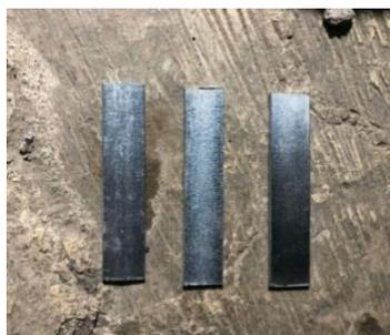
Gambar 5. Hasil spesimen setelah proses *Hot Dip Galvanising*
