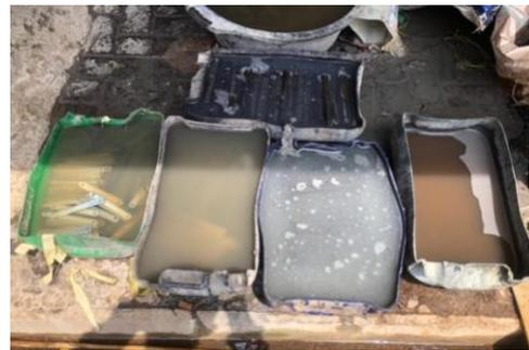
Gambar 3. Proses *Water Rinsing* dan *Acid Pickling*
