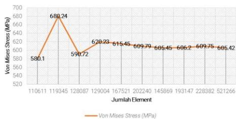
Gambar 8. Hasil *Grid Independence Test* Pada Simulasi
