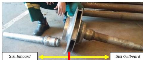
Gambar 4. Lokasi Patah Poros Pompa 107 JA
