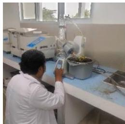
Gambar 2. Proses penguapan menggunakan *vacuum rotary evaporator*
